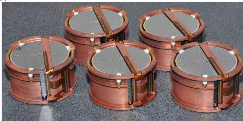
Un détecteur cryogénique est composé d'un cristal (germanium Ge, saphir  $\text{Al}_2\text{O}_3$ , tungstate de calcium  $\text{CaWO}_4$ ,...) refroidi à très basse température (20 mK = -273.13 °C) à l'aide d'une machine qu'on appelle cryostat.
