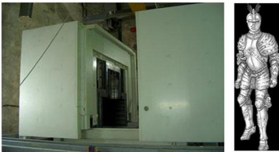
Blindages en polyéthylène (en blanc ~ 30 tonnes) et en plomb (en gris au centre ~ 35 tonnes) de l'expérience EDELWEISS installée dans le laboratoire souterrain de Modane
