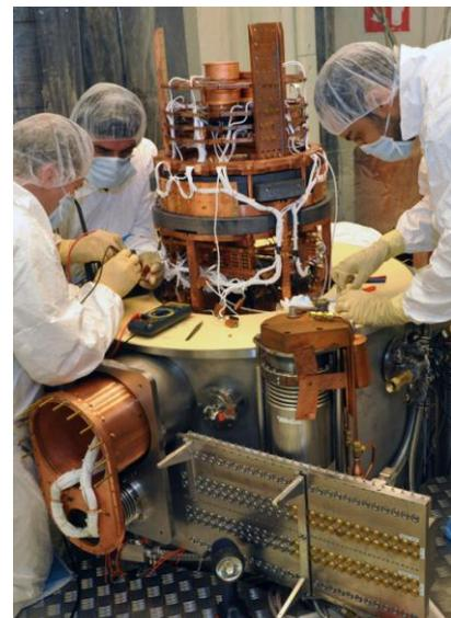
Pour protéger le détecteur de ces photons et neutrons on l'entoure de boucliers. La protection la plus proche du détecteur est un bouclier ou blindage en plomb qui permet d'arrêter les photons. Les neutrons, eux, vont être absorbés par du polyéthylène enveloppant l'ensemble détecteur et bouclier en plomb. Le polyéthylène est un matériau qui ressemble à la cire pour fabriquer des bougies.
