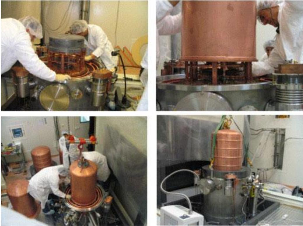
Différentes vues du cryostat de l'expérience EDELWEISS. Sur le plateau en plomb de la 1ère photo seront installés jusqu'à 110 détecteurs en germanium. Le cryostat est ensuite fermé avec différentes cloches en cuivre qui vont permettre d'atteindre des températures de l'ordre de 20mK
